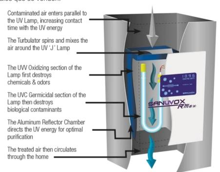
Diseño de lámpara UV patentado
